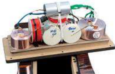
„Wax Coils“ für Bässe und Mitteltöner, Mundorf- Kondensatoren und ein „Z-Silvercap“ vom dänischen Spezialisten Jantzen (o.) in der Weiche
